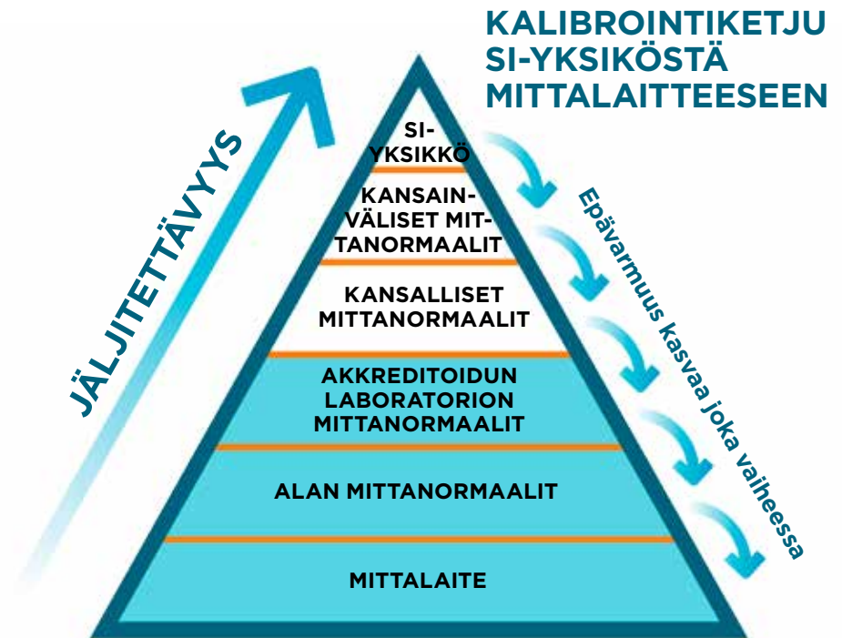
Kuva 1: Metrologinen jäljitettävyys (kalibrointiketju) SI-yksiköstä mittalaitteeseen. Vaisalan mittalaitteiden jäljitettävyystaso on merkitty sinisellä varjostuksella.
